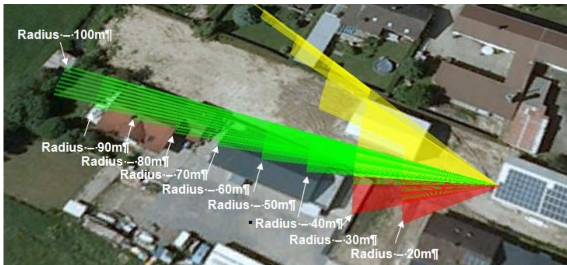
Abbildung 5: Darstellung der Berechnungsergebnisse von reflektierter Sonnenstrahlung (Abbildung betrifft nicht das Untersuchungsgebiet)
